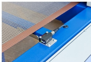
Possibilidade de equipar tunel com fotocelula de leitura de peça para economia de energia
