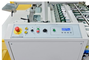
Display com LCD para fácil ajustes de varios temporizadores existentes
