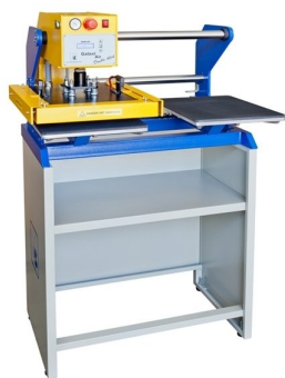
Cilindro pneumático de pressão de transferência com regulação de pressão
