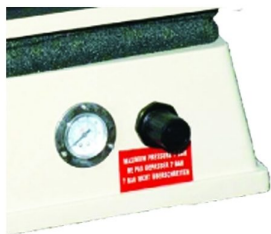
Cilindro pneumático de pressão de transferência com regulação de pressão
