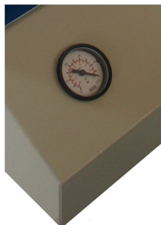
Indicação de valor de vácuo para nunca ter clichés mal abertos
