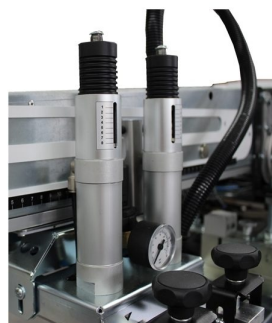
Pressão de impressão feito por 2 cilindros com ajuste individual
