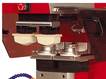
Sistema de impressão através de tinteiro fechado
