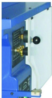
Velocidades de impressão independentes e reguláveis (avanço; recuo; subir, descer e pressão de régua raspadora);
