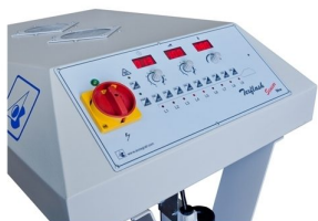
Display com indicação numerica do valor da potência das lâmpadas, tempo de secagem e temperatura real no material
