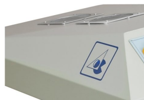
Ventiladores para homogeneização do calor
