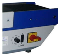
Possibilidade de regular intensidade da lâmpada
