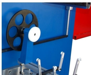
Acessório c/ cremalheira para aplicar roda dentada para grandes formatos como opção
