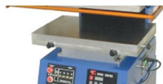
Micro registo de impressão com ajuste na mesa de colocação da peça
