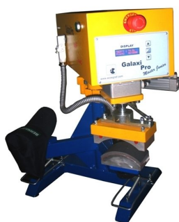
Barra de segurança no movimento lateral e prensagem
