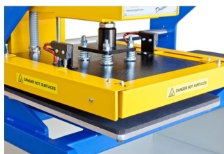
Barra de segurança no movimento lateral e prensagem
