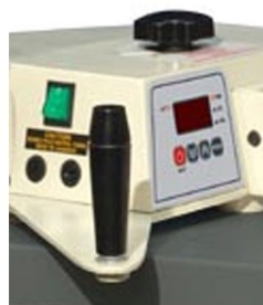
Controlador de temperatura e temporizador de prensagem digital
