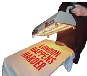
Fonte de calor com lampadas infra vermelhas
