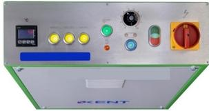
3 Zonas de calor com possibilidade de escolha independente e controlo de temperatura por PID
