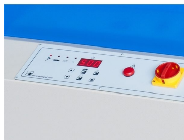
Programador digital com fotocelula de leitura de intensidade de luz
