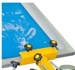
Aperto traseiro do quadro com ajuste de alcance
