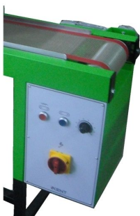
Tapete de teflon para transporte de peças delicadas e equipado com velocidade variável
