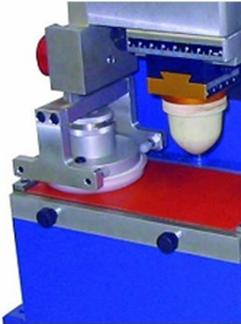
Sistema de tinteiro fechado com retiro e montagem rápida
