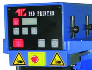
Painel LCD com possibilidades de temporizações independentes
