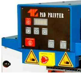
Painel com display contador de peças e paragem de emergência
