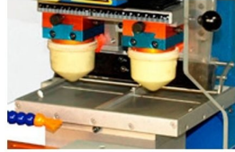
Sistema de impressão feito através de tinteiro aberto com possibilidade de impressão a 2 cores
