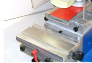
Ajuste micrométricos e de altura da mesa de colocação de peça
