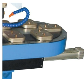
Sistema de transporte de peça tipo carrssel com 10 posições
