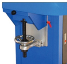
Mesa de impressão ajustável em altura
