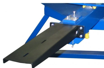
Suporte de paleta 100% estavel e robusto com ajuste de posição de paleta
