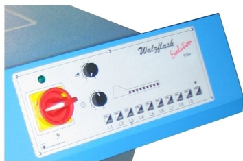
Painel de controlo com accionamento de lâmpadas independente
