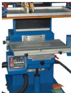
Desenho especial para ser capaz de imprimir objetos até 500 mm de altura
