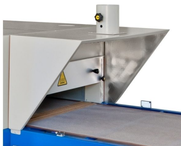
Cônes de aspiração de fumés dans à l'entrée et la sortie
