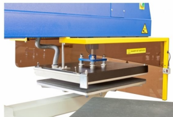
Fotocélulas de segurança nas cabeças de transfer para segurança do operador
