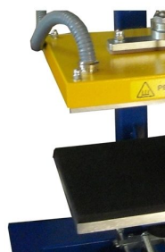
Curso de prensagem com 125 mm para prensagem em peças de elevado perfil
