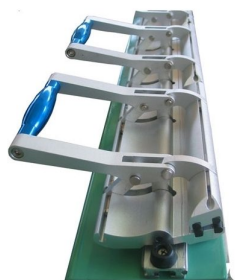
Pinças de elevada robustez para tensionar malha a altas tensões
