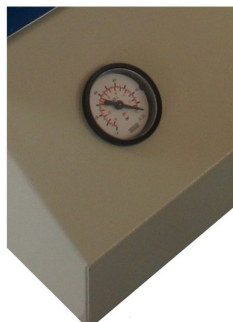
Indicação de valor de vácuo para nunca ter clichés mal abertos
