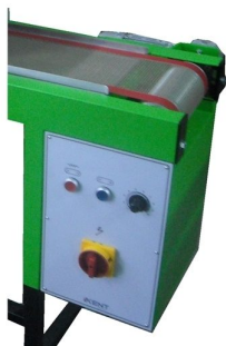
Equipada campânula com fonte de calor infra vermelhos Tapete de teflon para transporte de peças delicadas e equipada com ventiladores
