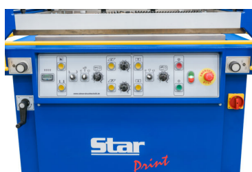
Display com LCD com diversas informações de velocidades, tempos, modos de trabalho, etc..
