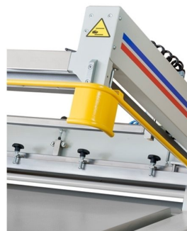
Barre de sécurité avec inversion automatique de descente pour assurer que l'opérateur est en sécurité au tour de la machine
