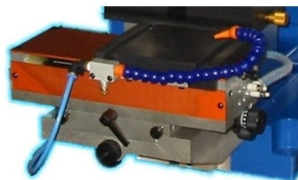
Mesa de impressão ajustável em altura; micro ajuste em eixo XX e YY
