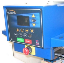
Painel LCD com ajuste de alturas de impressão feitas electronicamente
