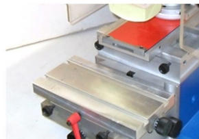
Ajuste micrométricos e de altura da mesa de colocação de peça
