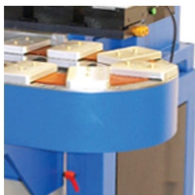
Sistema de transporte de peça tipo carrossel com 14 posições
