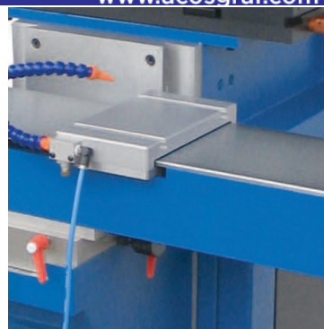
Sistema de transporte da peça feito por shuttle através de motor passo a passo
