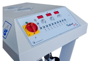
Display com indicação numerica de valor da potência, tempo de secagem e temperatura real
