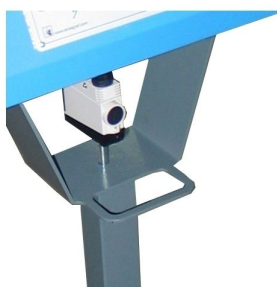
Pode ter opção de foto célula da leitura da paleta, start automático através do comando da máquina ou pedal
