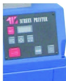
Painel digital com LCD e com diversos programas de impressão
