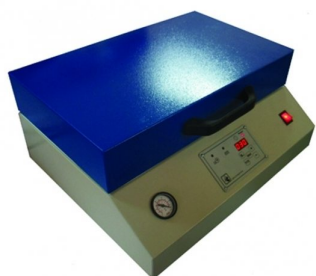
Sistema de impressão por tinteiro fechado
