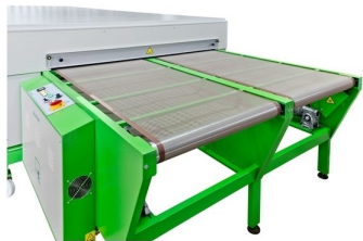
Possibilidade de colocação de duplo tapete com velocidades independentes como opção
