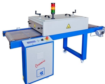
Ventilador para homogeneização do calor e punho com START/STOP na pega
