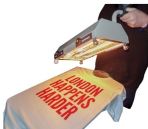
Fonte de calor com lampadas infra vermelhos
