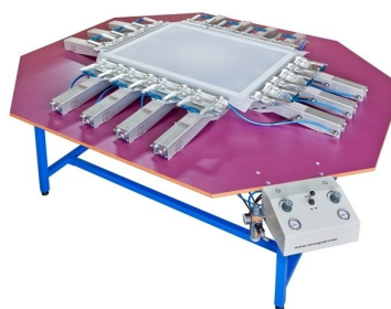
Gavetas de quadros rolam sobre rolamentos para perfeito deslize
