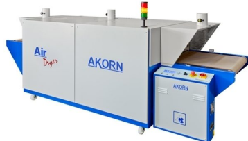
Tuneis de secagem de impressão feita em DTG disponiveis em diversos tamanhos
