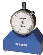
Tensiometros para medição da tensão na malha disponíveis
