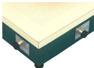
Registos micrométricos de impressão no tampo de vácuo
