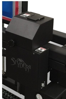
Tecnologia de impressão através CERA (não utiliza tinteiros, nem tintas, nem cabeçais de impressão)
